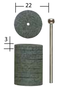
NO 28 270 2 bucati Biax-uri silicon-carbid Pentru gravarea sau matuirea sticlei, ceramicii etc. De asemenea pentru prelucrarea aliajului tungsten-carbid, a fontei si a altor aliaje dure de otel. Diametrul axului de prindere 2.35.
